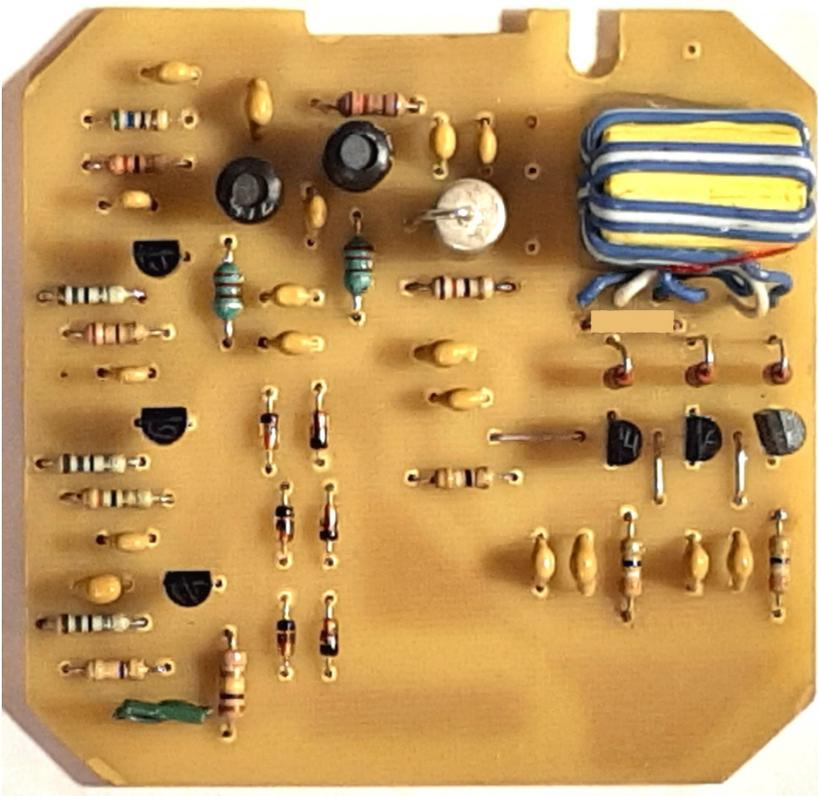
Рис. 14. Внешний вид платы АУ со стороны элементов.
