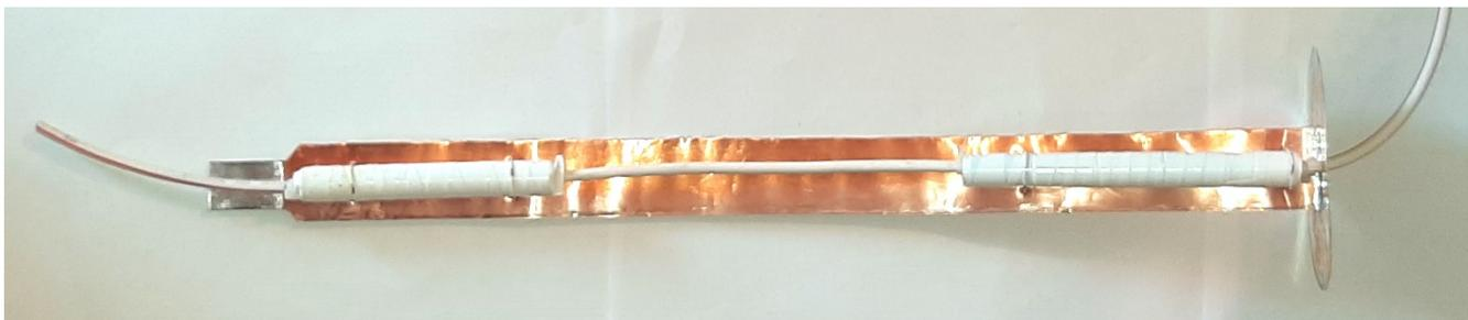
Рис. 15. Вывод выходного коаксиального кабеля.
