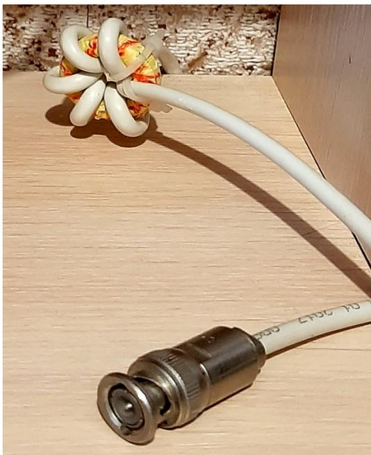
Рис. 16. Запорный дроссель на конце антенного кабеля.
