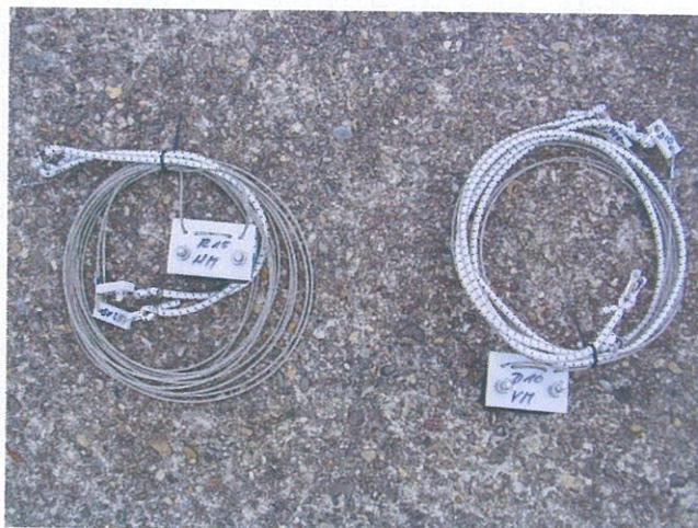
aufgerollte Drahtelemente R15 und D10 mit montiertem Gummiseil und Halbschalen sowie Kunststoff-Plättchen zur Rohrmontage
