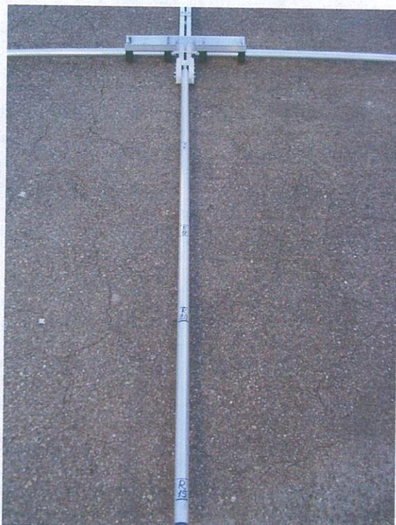
An der Vierkantrrohr-Phasenleitung befinden sich hinten (kurz vor der 10m Plattform) die Kunststoff-Klemmbacken, an die die rückseitige Rohrverlängerung anzubringen ist.
