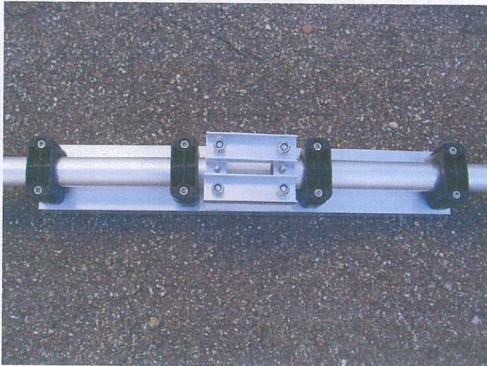
Untersicht Elementplattform mit eingefügtem 10m Strahlerrohr und Montage-Verstärkungsriegel
