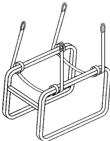
Чтобы перенести генератор, надежно прикрепите к его каркасу два стропа, как показано на рисунке.
